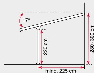
Montage adaptable grâce à une hauteur de toit variable et des poteaux déplaçables.
