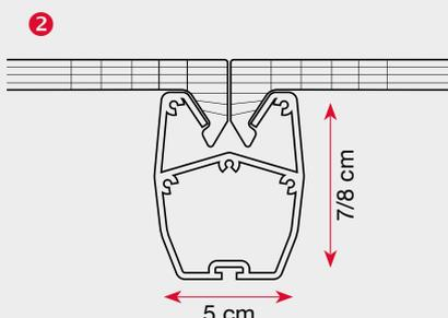
Les plaques alvéolaires polycarbonate de 10mm d'épaisseur se clipsent dans les chevrons.
